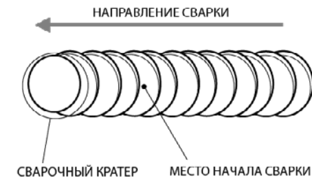
Рис. 9.4. Начало сварки при смене электрода.
